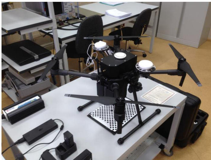
Рисунок 1 - Радиоизмерительный комплекс на базе БПЛА Matrice 210 RTK
